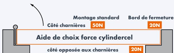
La force de cylindre dépend de la position de montage
