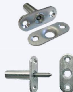
DICTATOR HLS-catch (Hot Locking Safe-catch) est un fusible thermique qui est verrouillé en position de repos. La solution pour éviter le gauchissement des portes coupe-feu et ainsi d'éviter le risque de pénétration de feu.
